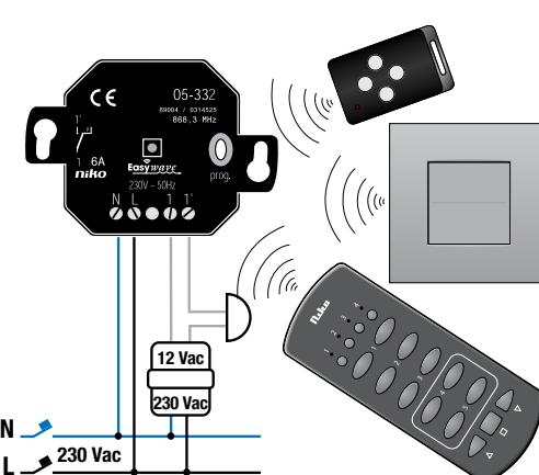
**! Dieses Produkt muss mit einem Leistungsschalter (MCB) von max. 6 A im Schaltschrank abgesichert werden. Der MCB-Wert ist durch nationale Installationsvorschriften begrenzt.**
