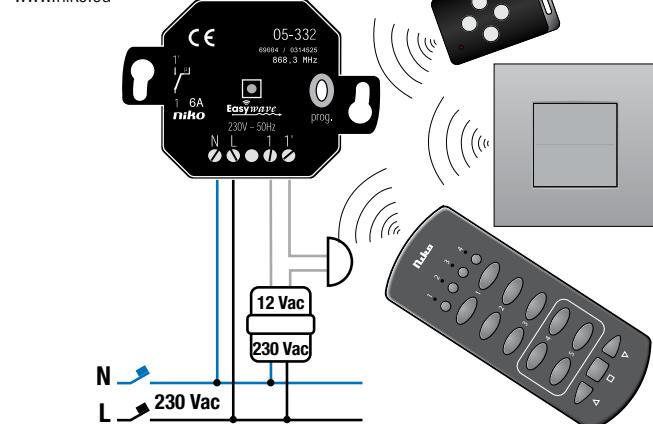
Dit product moet worden afgerekend met een vermogenschakelaar van max. 6 A in de zekeringkast.
