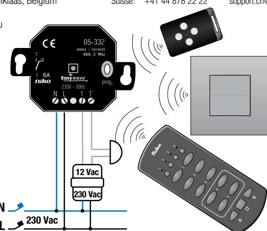
**! Ce produit doit être protégé par un disjoncteur miniature de max. 6 A dans l'armoire électrique. Le calibre du disjoncteur miniature est limité par les règles nationales en matière d'installation.**
