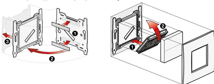
**2. Vissage:** sur une surface structurée comme des murs en pierre, du plâtre...
