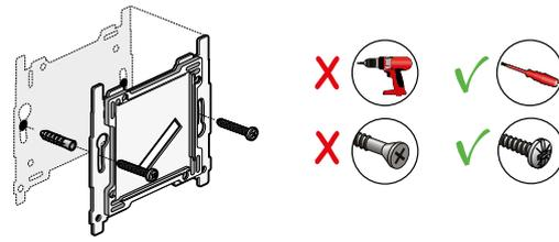
Wenn Sie einen bereits montierten Schalter in einer vorhandenen Anlage vertikal zu einem 2-fach-Schalter **ERWEITERN** möchten, verwenden Sie hierzu bitte einen zweifach vertikalen Abdeckrahmen mit Mittenmaß 71mm. Der **AUSTAUSCH** eines in einer Einbaudose für Schraubbefestigung montierten Schalters ist möglich, wenn die Schrauben horizontal liegen.
