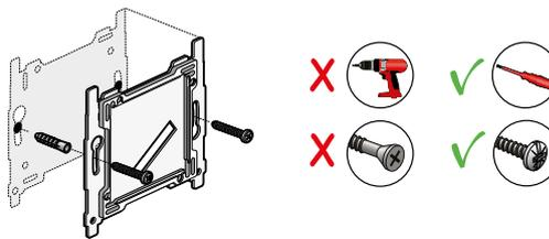
Vertikal **UTBYGGNAD** av en strömställare i en befintlig installation till en dubbel strömställare är möjligt med hjälp av en dubbel vertikal täckplatta med 71 mm från mittpunkt till mittpunkt.
