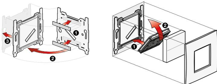
**2. Schroeven:** op gestructureerde ondergrond b.v. stenen muren, pleisterwerk...
